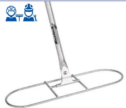
Bases metálicas fabricadas bajo especificaciones que las hacen las más resistentes al uso rudo. El bastón es de lámina calibre 20 y cuenta con un refuerzo en la punta para prevenir fracturas por la fatiga del material.
